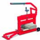
Lámačka zámkovej dlažby
